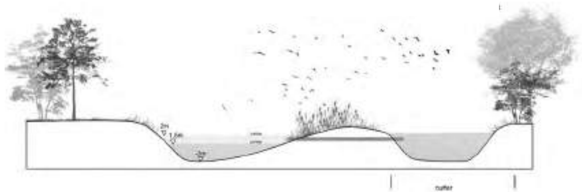
Figuur 28 ecologische snede beek met waterbuffering voor de landbouw
