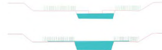
Figuur 13: Concept werking helofytenveld voor overstortwater.
