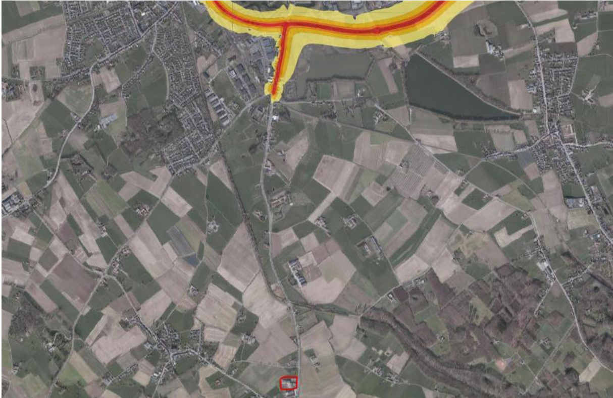
Figuur 21: Geluidsbelasting wegverkeer
